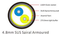
4.8mm SUS Spiral Armoured
